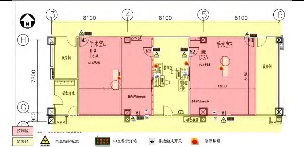
图 10-2 DSA 手术室辐射安全与防护设施布置示意图
